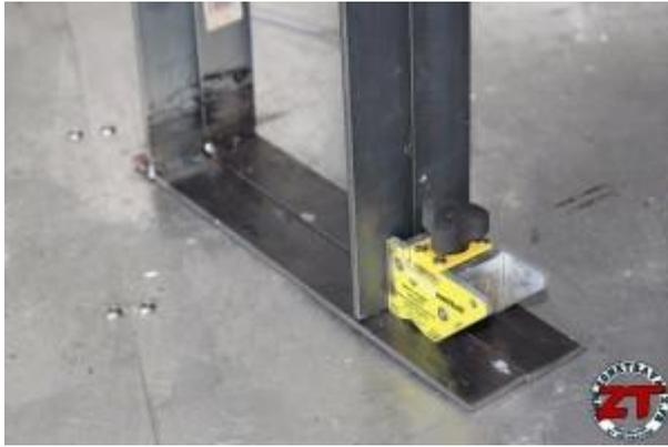
Enfin (et on voit bien sur les photos qu'il m'a déjà bien servi !), pour la fabrication d'un objet qui n'est pas encore sur ZoneTravaux... mais bientôt : Maintien des pièces avant soudure ou encore soudure à 45°.
