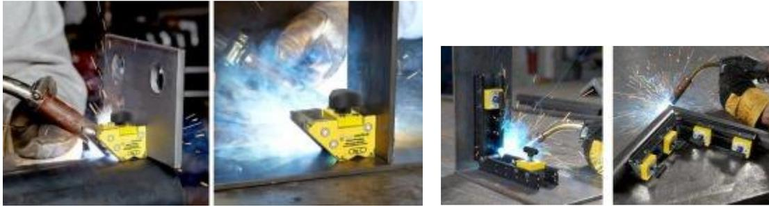
Malgré sa taille, ce petit aimant a une force de 40 kg sur du métal de 6 mm. C'est vraiment pas mal. Ne comptez pas non plus fixer de lourdes charges dessus, ce n'est pas fait pour. Le deuxième intérêt de cet aimant, c'est la possibilité de souder vos pièces avec des angles de 45 et 90° (les principaux angles utilisés en soudure).
