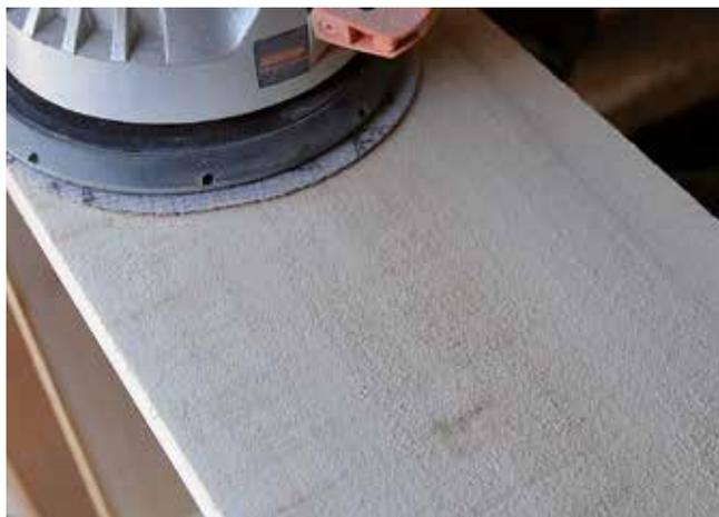
En mode de rotation imposé, le ponçage est particulièrement rapide et efficace, mais l'état de surface obtenu est de qualité moyenne. Ce mode d'utilisation est recommandé pour des travaux grossiers sur des surfaces présentant des défauts importants.
