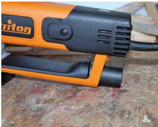
La buse d'extraction des poussières est plutôt bien placée – à l'arrière sous la poignée – et ne gêne en rien le travail. Attention à l'entretien de cette dernière lors de travaux de ponçage importants avec des abrasifs à gros grains. Le système d'aspiration doit être efficace pour pouvoir aspirer sur le long terme les déchets importants. En cas de refus d'aspiration, il faudra démonter la buse et le plateau.
