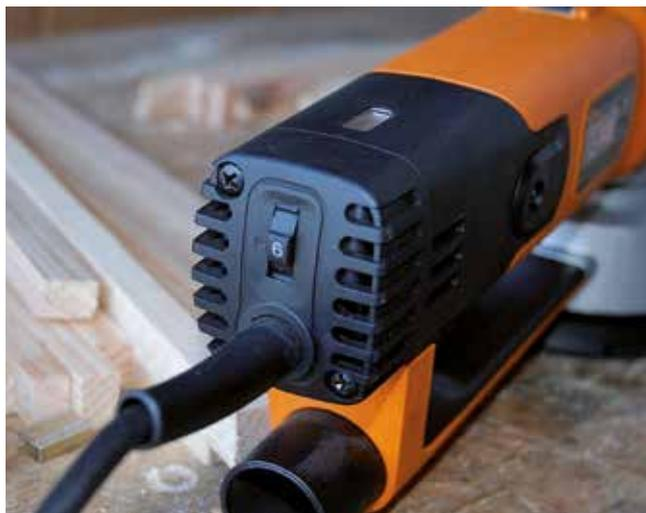
La ponceuse Triton est équipée d'un contrôle de vitesse électronique qui permet de maintenir la vitesse sélectionnée de manière constante même sous charge. À défaut de connaître la bonne vitesse à adopter, il est toujours préférable de commencer par une vitesse basse et d'augmenter progressivement jusqu'à obtenir le résultat optimal souhaité.
