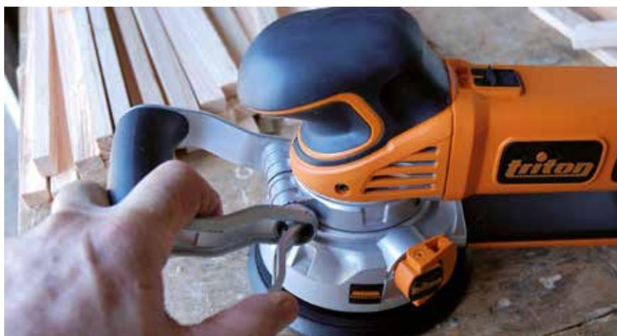
Après avoir desserré le mécanisme de blocage et réglé la hauteur, il suffit de serrer le levier de réglage pour obtenir un parfait blocage dans la nouvelle position.
