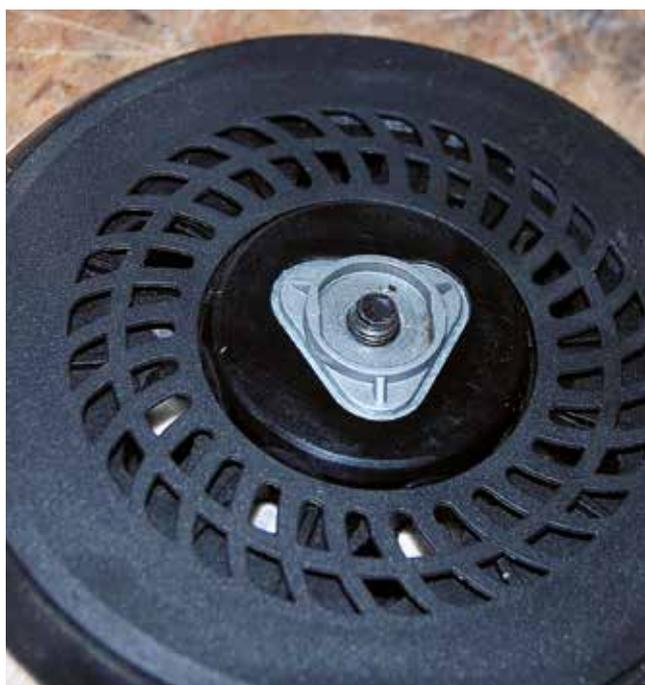
*Attention, lors de travaux intensifs et/ou longs, à veiller à ce que l'intérieur du plateau reste parfaitement dégagé et n'accumule pas les déchets.*
