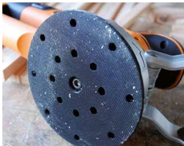
Une classique surface auto-agrippante recouvre le patin. Pour peu que vous soyez vigilant à changer le disque avant son usure complète – et à toujours travailler avec un système efficace d'aspiration –, ce système est garant d'une parfaite efficacité et d'une bonne tenue dans le temps.
