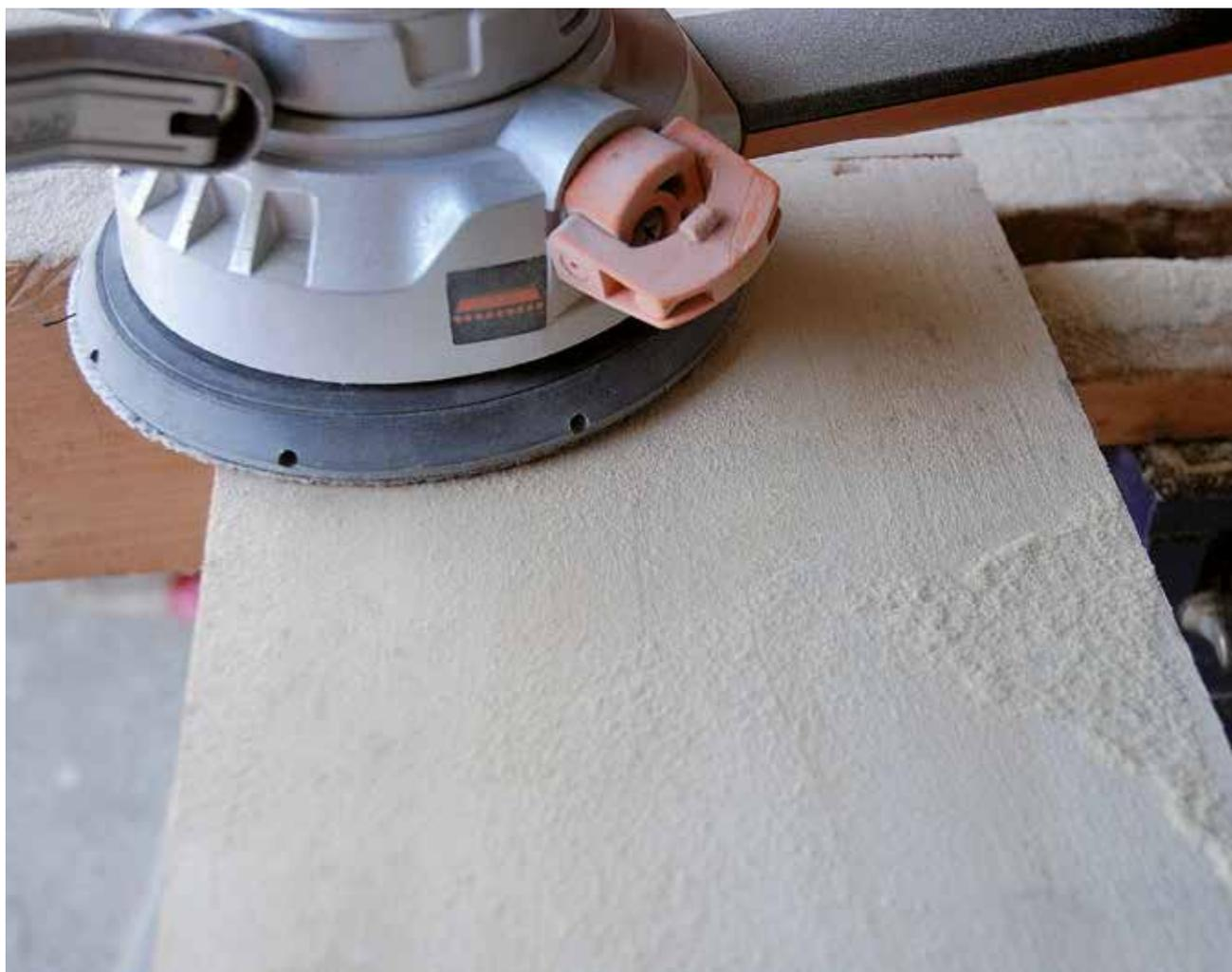
*Avec une ponceuse à ponçage orbitale, il n'est guère possible de travailler sans aspirateur ; les fines poussières sont fortement mises en suspension dans l'atmosphère, ce qui est très mauvais pour la santé de l'opérateur, et celles qui restent sur la surface travaillée nuisent à la qualité du résultat.*
