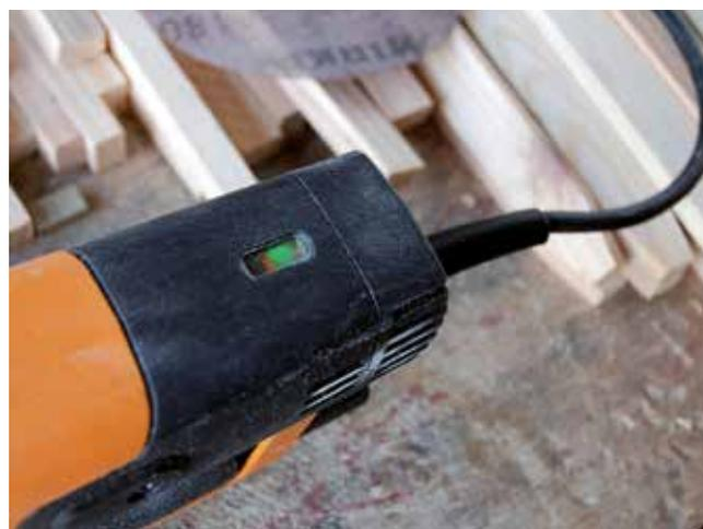
Un témoin d'alimentation à diode verte indique que la machine est sous tension... au moins, on sait quand la machine est branchée, plus besoin de tirer sur le fil pour vérifier.
