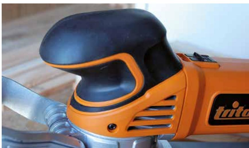
La poignée principale sur le dessus de la machine, avec son revêtement bi-matière, offre une bonne prise en main et permet un appui ferme pendant le travail de ponçage.
